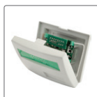
Wi RX 8 - 433 Ricevitore radio con 8 uscite O.C. e 3 uscite a relè
